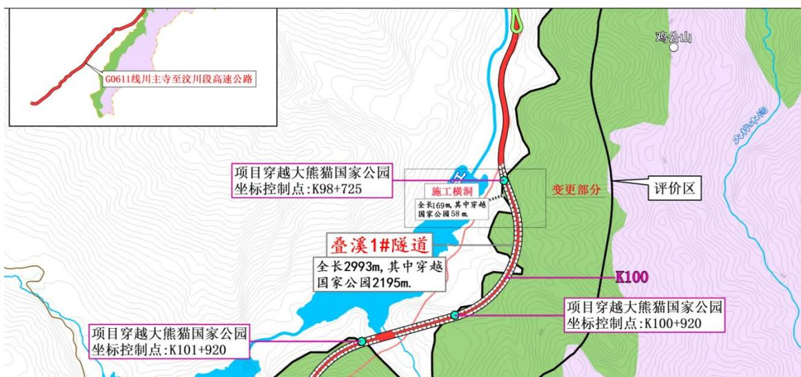
图 2.3-14 变更后图（增加 1 处施工横洞）
