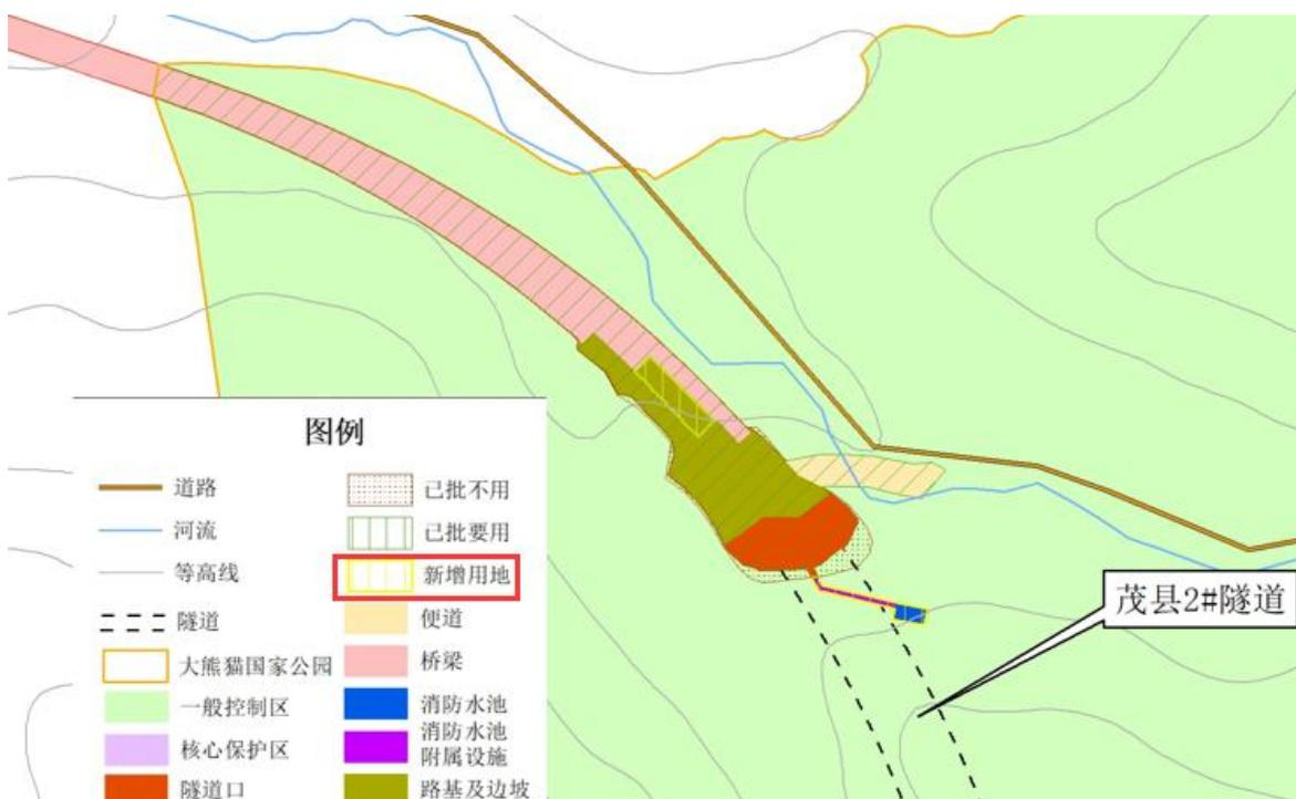
图 2.3-20 变更后图（新增路基及边坡）
