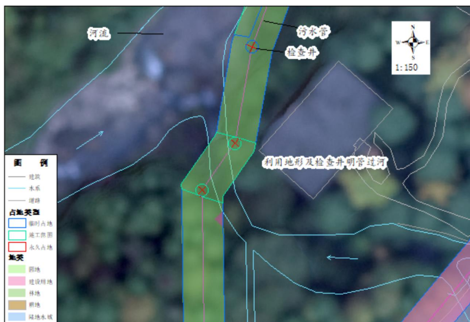
图 2.11.7 污水处理站沿河 4 段布局图
