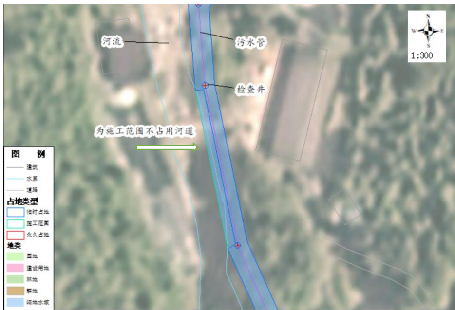
图 2.11.8 污水处理站沿河 5 段布局图
