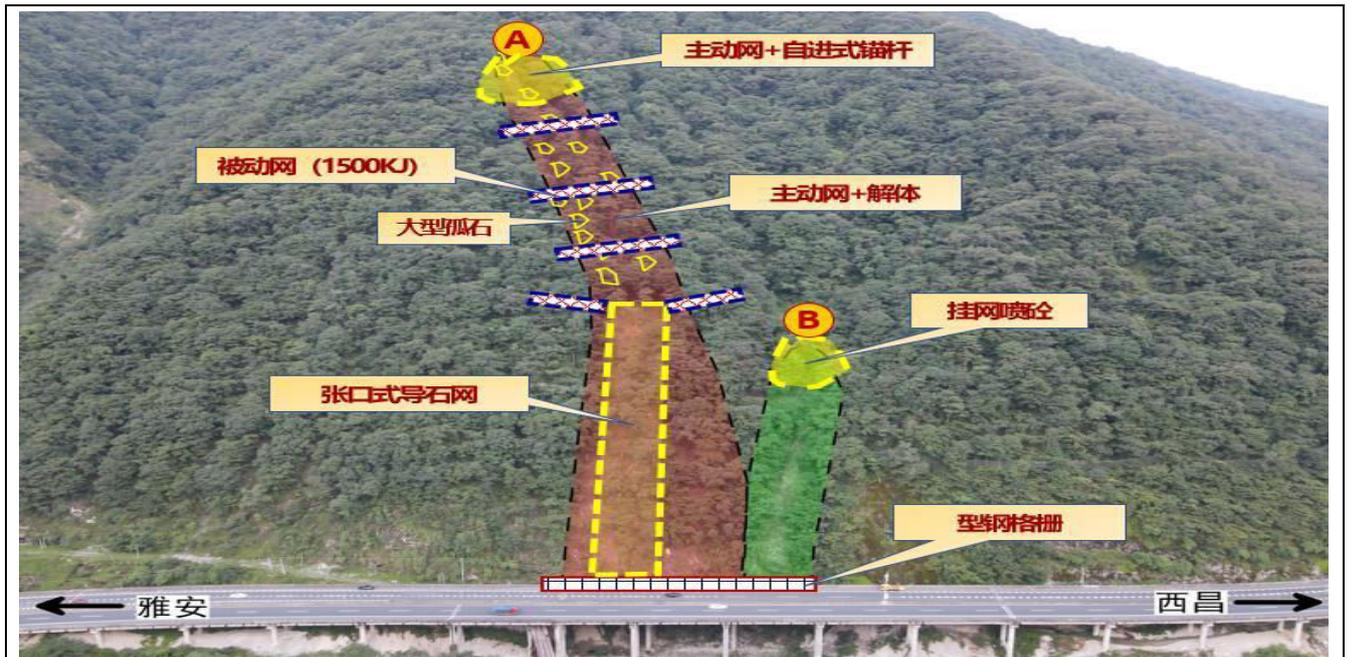
图 2-15 防护阶段处治设计平面布置图
