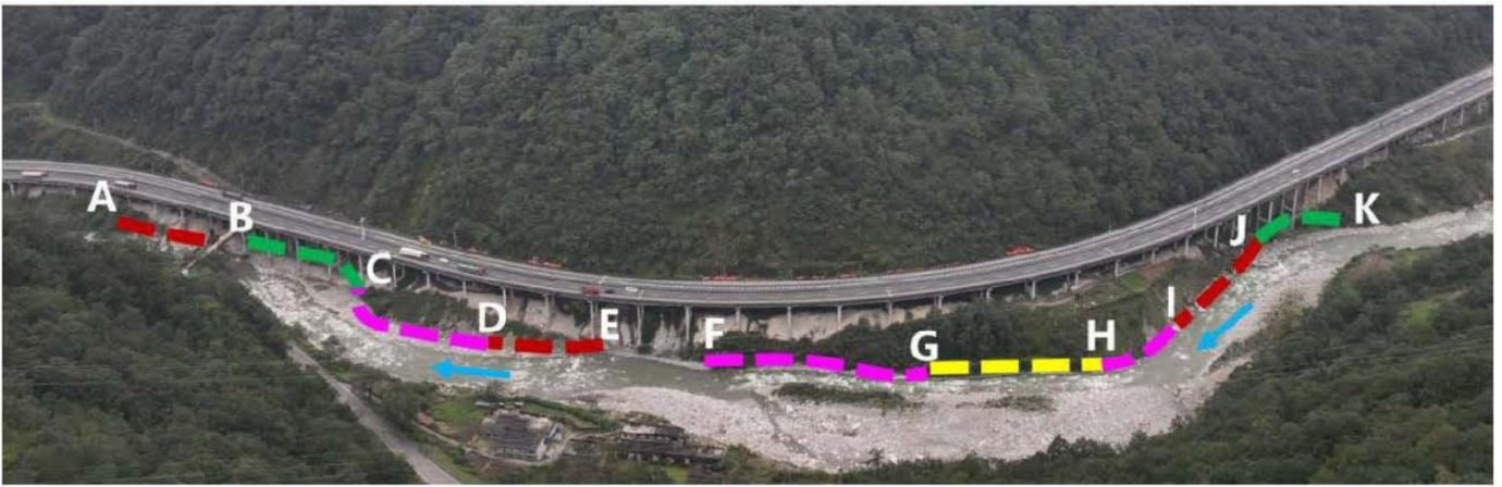
图 2-17 下边坡防冲刷设计平面布置图
